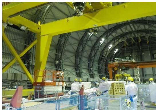
1/2号排気筒の解体装置
