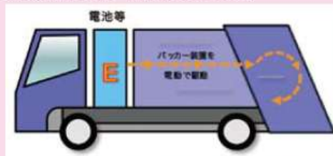
図2 電動式塵芥収集車のイメージ
